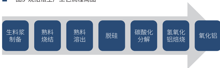
■ 图3 烧结法生产工艺流程简图
